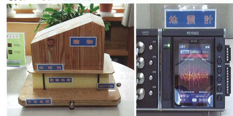
左：合板とスポンジで作った模型 右：支持地盤に見立てた合板を揺らした際の加速度波形。地盤（赤色）と比べて杭基礎がある建物（黄色）の加速度は抑えられている（写真：住環境設計室）
